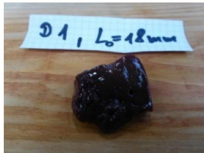
Abb. 3a, b: Versuchsaufbau Druckversuch und Probenmaterial (nach dem Versuch)
