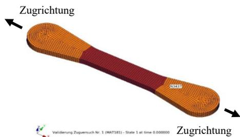
Abb. 4a: FEM-Modell des Zugversuches
