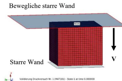
Abb. 4b: FEM-Modell des Druckversuches
