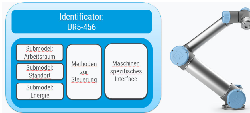
Abbildung 2 Schematische Darstellung einer Asset Administration Shell eines Universal Robots Industrieroboters
